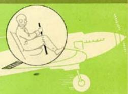
Пользоваться тормозами на пробеге плавно, не допуская резного торможения колес. Торможение начинать после того, как самолет пробежит 30 – 40 м.
