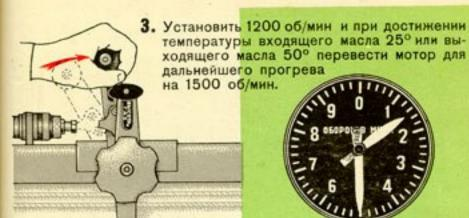
Мотор считать прогретым при достижении следующих температур:
